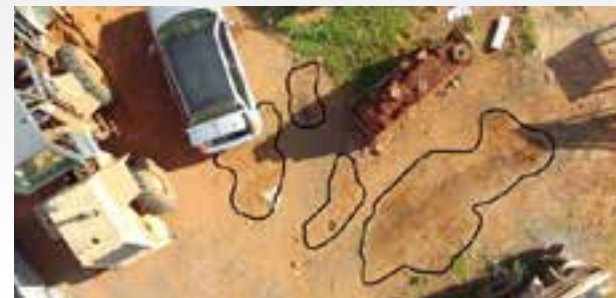
Vista aérea de algumas das manchas de óleo (material pétreo) que contaminaram o solo.
